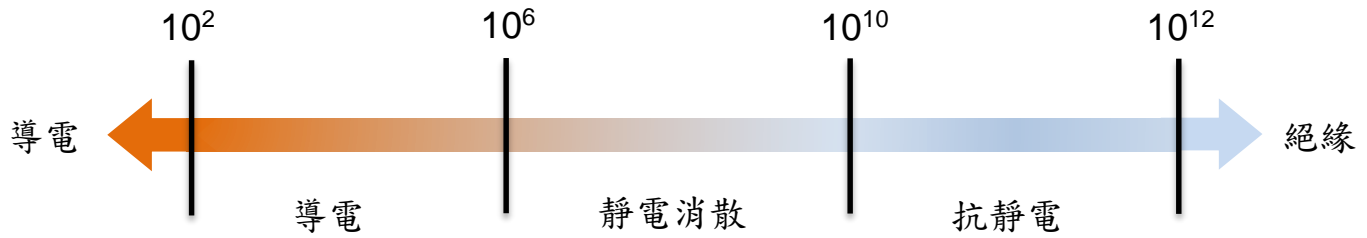
Semitron® ESD 225 – Acetal 抗靜電(表面阻抗值10 9 ~10 11 )
